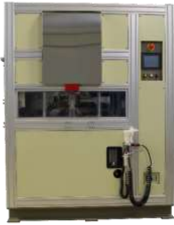
RTM 摩擦試験機 (MODEL FR-7225)
